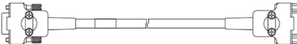
CAN 인터페이스 케이블, OBDII J1962 - Lemo 1B FGC (16mc-8mc), 2m5
