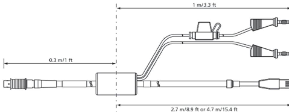
Câble de connexion Ethernet au PC et d'alimentation, Lemo 1B FGL - RJ45 - Fiches banane de sécurité (8fc-8mc+2mc), 3 m
