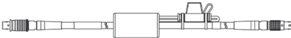
Câble de connexion Ethernet au PC, très flexible, Lemo 1B FGF - Lemo 1B FGL (8mc-8fc), 0m5
