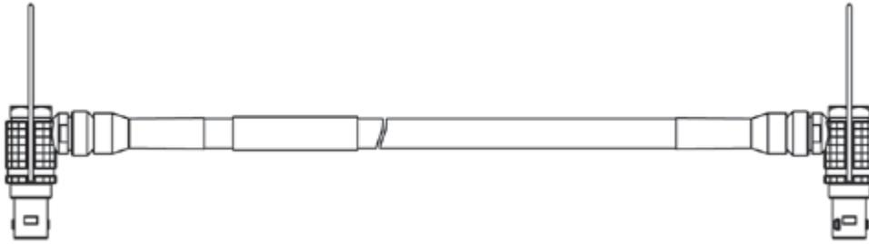
**5 - Fast Ethernet-Verbindung mit XETK oder ES910-Modulen (benötigt das Adapterkabel CBAE330)**
