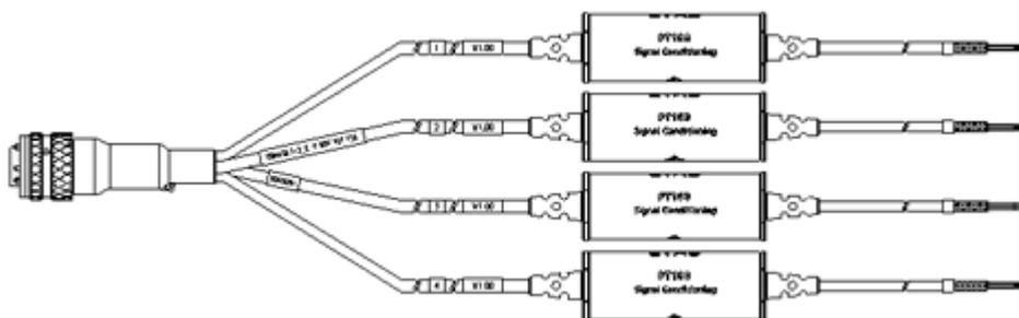
PT100センサ接続ケーブル, 2 PT100チャンネル+27ナグ'入力チャンネル, Souriau 8ST12-35-4xオープンワイヤ, 2m
