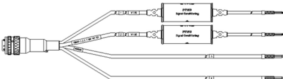
PT200传感器连接电缆、PT200、4通道、Souriau 8ST12-35 - 4x明线、2 m
