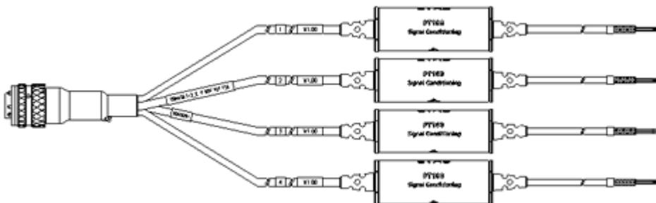
PT100传感器连接电缆、2个PT100通道 + 2个模拟输入通道、Souriau 8ST12-35 - 4x明线、2 m
