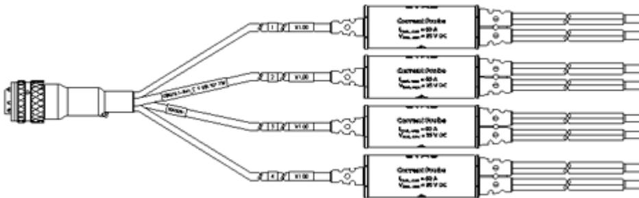
電流プローブ、±5A 幅、4チャンネル、Souriau 8ST12-
