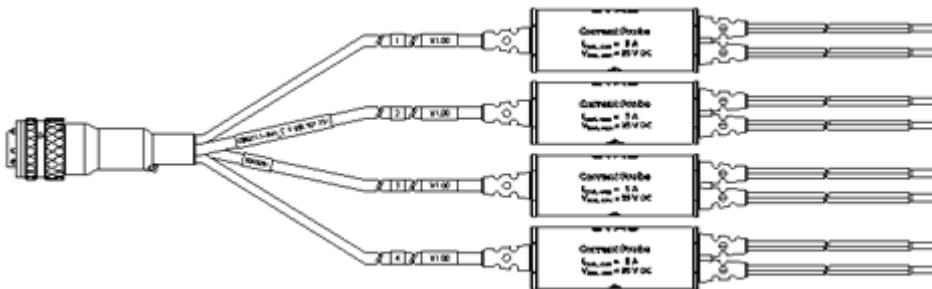
電流プローブ、±30A 幅、4チャンネル、Souriau
