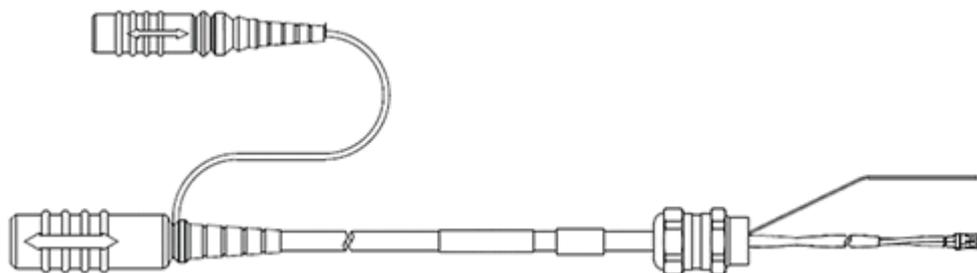
BR\_XETKM12 나사 고정 장치에 미리 조립된 ECU 어댑터 및 전원 공급장치 케이블, ECU 하우징의 차폐 장치, Lemo 1B PHA - MOLEX (2fc-2fc) / Lemo 1B PHG - 오픈 와이어 (2fc-1c), 1m8
