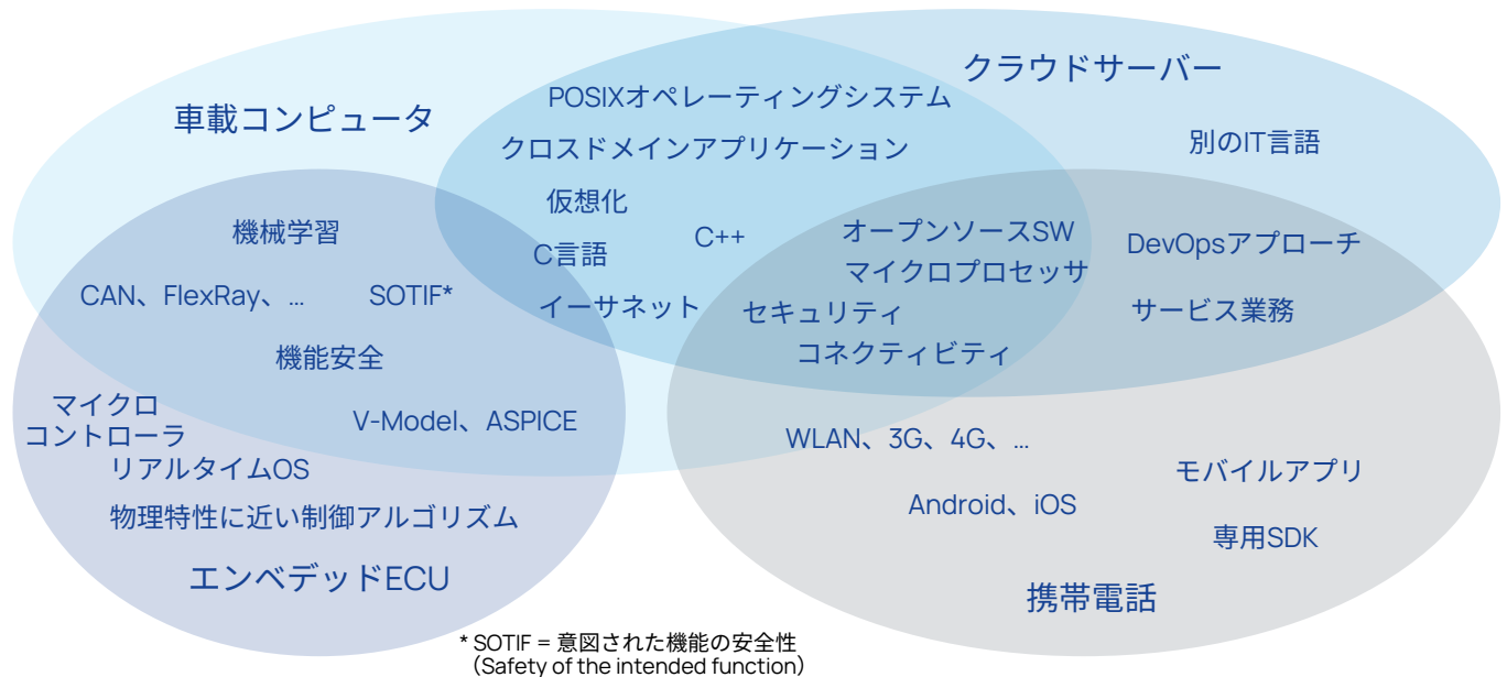
図2：SDVは、従来の深く組み込まれたソフトウェアのほか、新たに多くの種類の自動車ソフトウェアを導入している。
