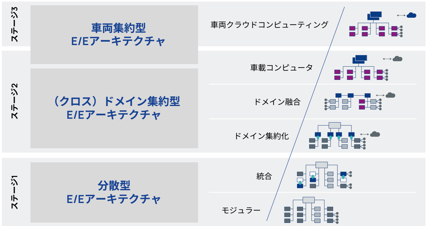
図7：E/Eアーキテクチャの開発によるSDVの実現
